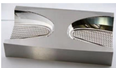
Werkstückgröße: 200mm x 100mm Bearbeitungstiefe: 38,02mm
